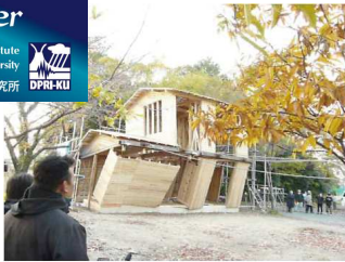
補強試験体の倒壊直前の状況 (4P)
