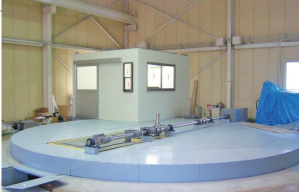
本装置は1989年に導入(その後、2010年に大改修)されたビーム型の遠心力載荷装置で、遠心力を利用することで実物と等しい応力状態を縮小模型内に再現できることから、縮尺模型を用いながらスケールの大きな土構造物(盛土、斜面等)や地盤-構造物系の変形・破壊挙動を調べることができます。
