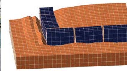
左: 2011年東北地方太平洋沖地震・津波で被災した岸壁 Left: Damaged quay walls after the 2011 Off the Pacific coast of Tohoku earthquake 右: 重力式岸壁の3次元有限要素法による変形シミュレーション Right: 3D simulation of gravity quay walls during earthquakes
