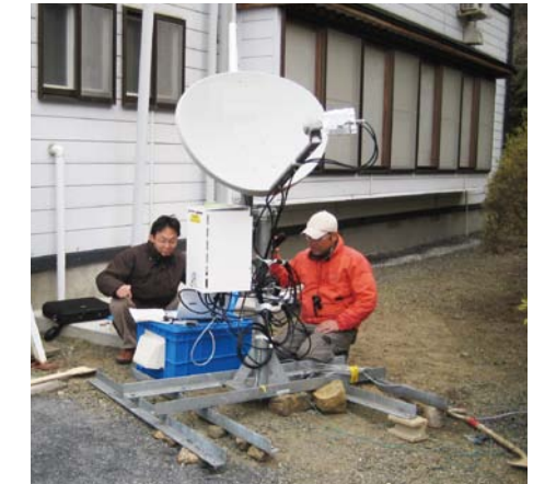
衛星通信を使ったリアルタイムデータ伝送 (東北地方太平洋沖地震緊急余震観測) Telemeter observation using a satellite data link
