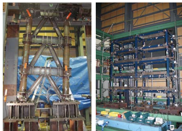
左：高強度CFT柱を用いたロッキングフレームの性能検証実験 Left: Testing of rocking frame with super high-strength CFT columns 右：被災建物の健全度判定システムの開発 Right: Development of structural safety assessment system for damaged structures
