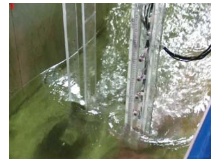
人体が受ける流体力に関する水理実験 Hydraulic experiment of fluid force acting on a human body
