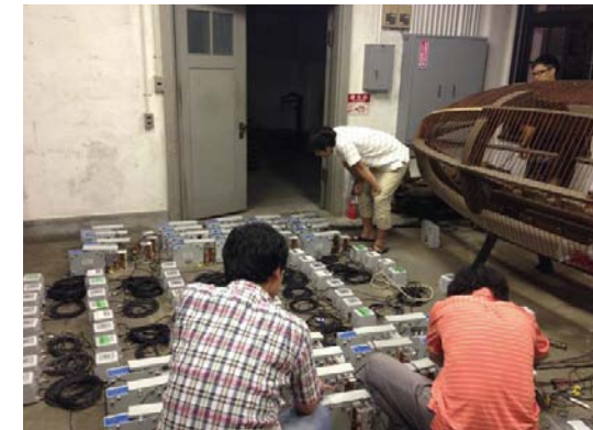
精密観測（満点計画）用の小型地震計の整備 Portable seismometers for the dense array observations
