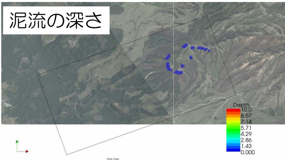
地盤が水で飽和している条件で土石流の数値シミュレーションを実施すると、土石流が下流域まで到達する。
