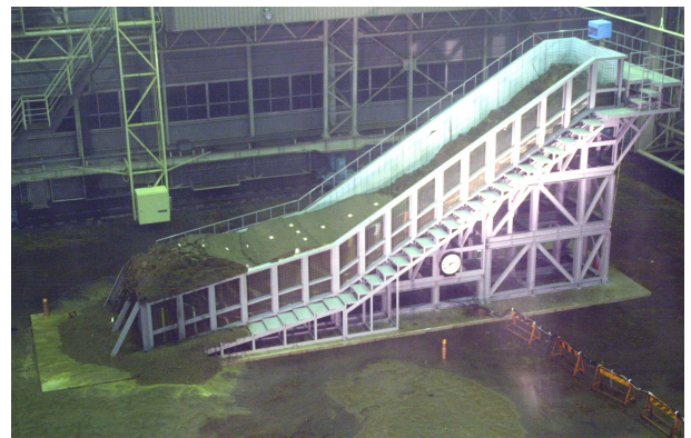
図1 大型模型実験装置(崩壊後)
