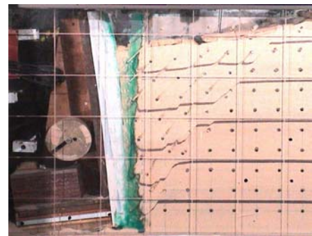
図2 402gal加振後の擁壁模型と背面地盤
