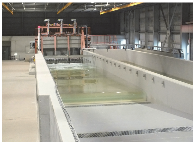
図1 津波再現装置における波の造波
