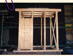
壁柱試験体の120%入力実験後の状態
