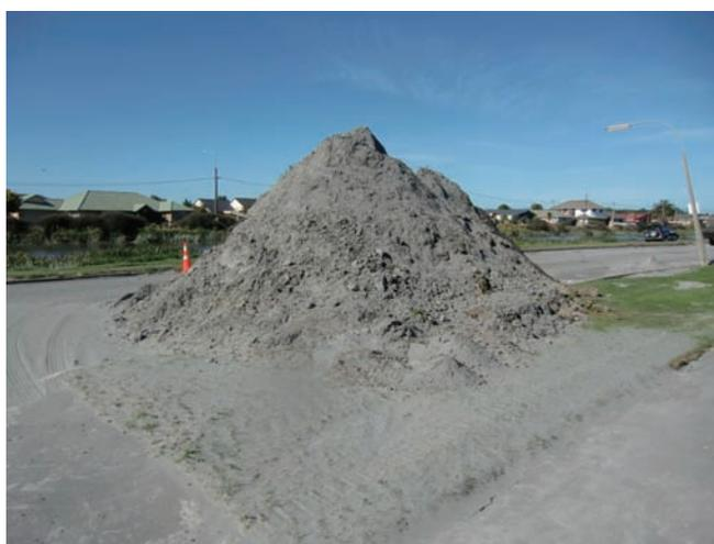
写真3 液状化により噴出した砂の山
