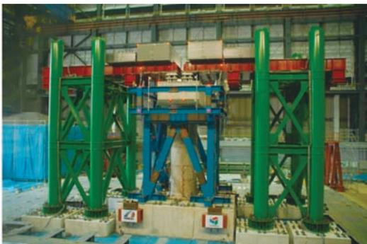
高さ7.5m 橋脚直径2.0mの実物大橋脚模型
