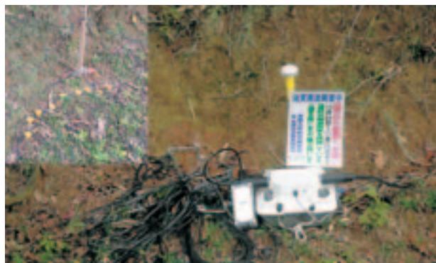
図6 地震計（左上の黄色のもの）とレコーダ、地震計は6～9台がセットで1観測点に設置された。このレコーダは6成分からなり、50～100m間隔で6点の観測ができる。GPSのアンテナを装備し、この時計で離れた観測点でも1msの精度で記録の同期が可能になる。新宮―舞鶴測線ではこのレコーダーが240kmにわたって、300個以上設置され、他の計器と併せて約2400点の記録がとられた。
