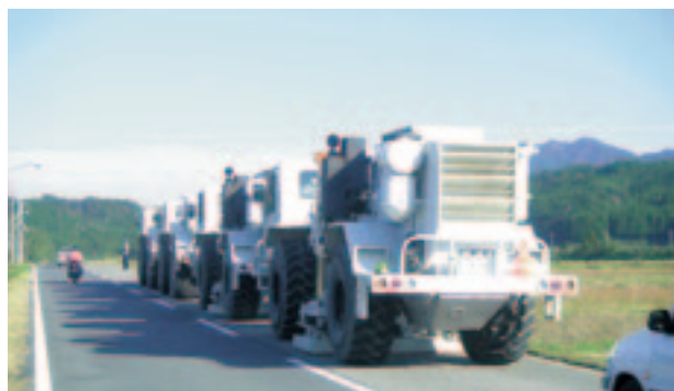
図5 バイプロサイス、1～4台が用いられ、同期した発信がなされ、数十回から数百回の信号が重合処理された。
