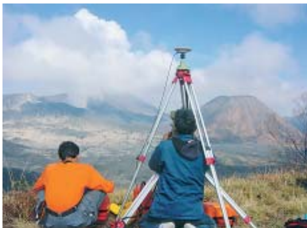
噴火後、緊急に行われたGPSおよび光波測距儀による火山体の地盤変動観測。前方に白色の噴煙をあげるプロモ山が見える。
