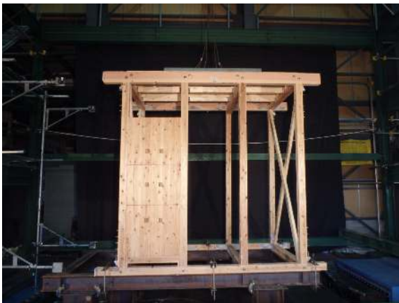
写真 2 : 合板で補強した試験体の実験後の状況
