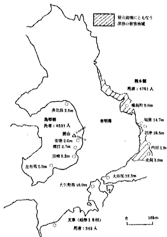
図-17 有明海沿岸の被害状況 死者：菊池, 1980「日本の歴史災害」より 津波高：都司ら, 1993より
