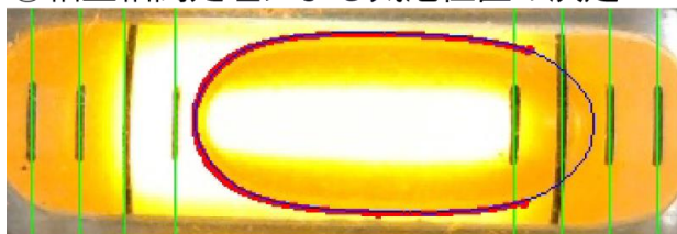
図2：気泡型傾斜計の画像データ解析。
