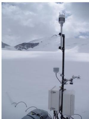
図4(左) Bordu 氷河における気象観測機器。左下には雪に埋もれた宇宙線雪量計。
