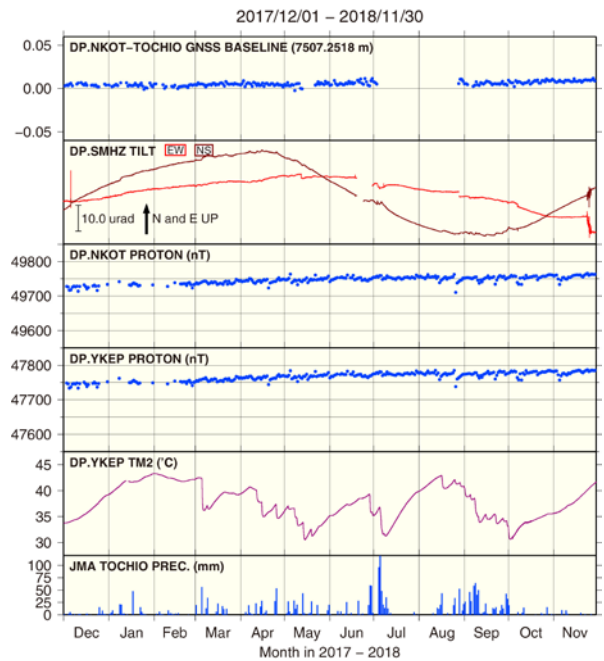
図 3-2：焼岳に展開している観測項目のうち、地震観測以外の各種データの時間変化。上から順に、中尾峠・栃尾間の基線長、上高地下堀沢での傾斜変動、中尾峠の地磁気変動、焼岳山頂の地磁気変動、焼岳山頂の地中温度、気象庁・栃尾のアメダス観測点での日別降水量を示す。2017 年 12 月中旬から 2018 年 12 月中旬までの 1 年間の変化をしめす。今回の群発地震活動の時期にはこれまでの季節変動を越える変化は認められない。 ※上高地・下堀沢傾斜計の 11 月末の変動は有感地震による物理的な振動によるもの。
