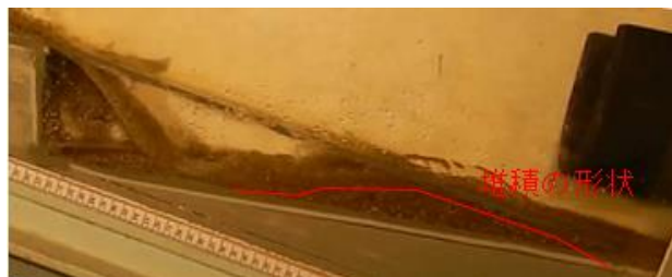
図-4 ステップ内部に堆積した土砂の形状
