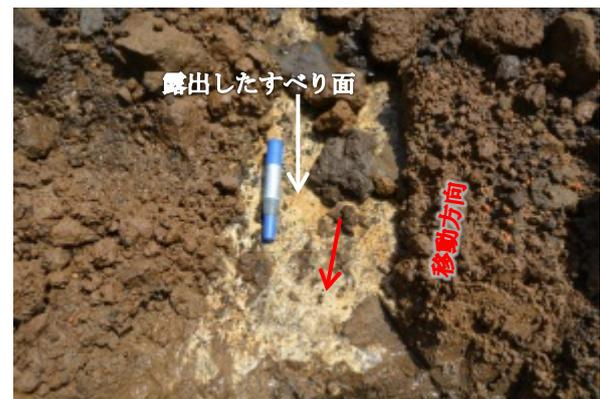
写真-2 源頭部に露出したすべり面。薄く引き延ばされて付着していた「草千里ヶ浜火山降下軽石」（約 2.6 万年）とすべり面を流下する地下水
