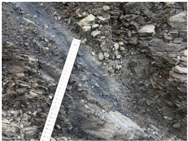
図-2 スレートの座屈変形：スケッチ（上）、写真（中）、軸部の拡大（下）
