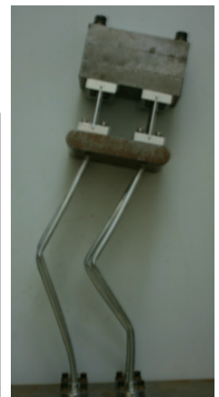
写真1 最終崩壊状態
