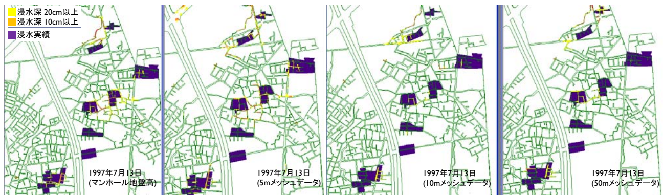
図-2 各地盤高データを用いた氾濫解析結果
