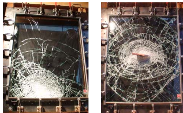
左下に瓦を加撃 中央に瓦を加撃 図3 合わせガラスの破壊性状
