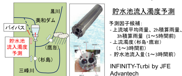
図 1 美和ダム流域図(上流：杉島、鷹岩、貯水池：バイパス入口)と濁度計(INFINITY-Turbi)
