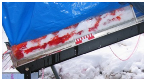
図-1 融雪実験の様子：染料によって融雪水の浸透挙動を観察
