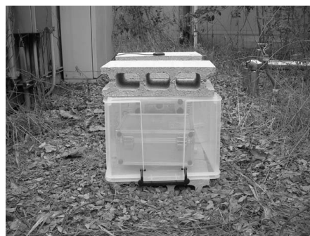
図 1 地震計設置の様子
