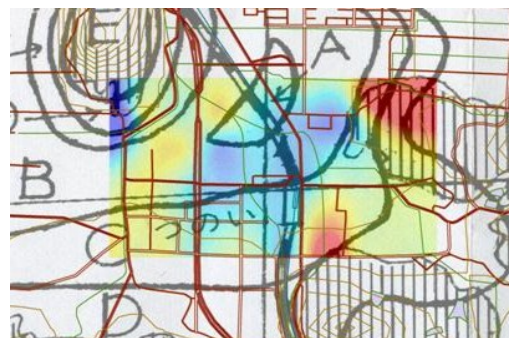
図 対象地域の地盤卓越周期分布と 1943 年鳥取地震の被害分布 2)
