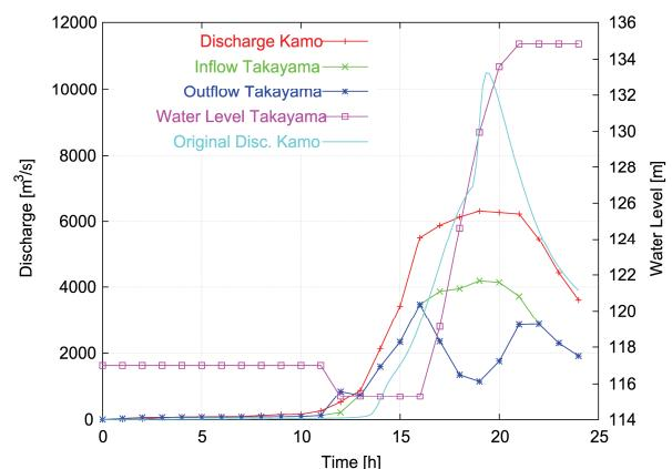
図 現行の規則に基づいて操作した場合（水色）と最適化した場合（赤色）との加茂地点における流量の比較。最適化した場合の高山ダムの流入量・放流量・水位を併せて示している。
