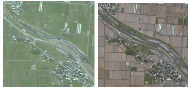
写真1 千代川支川袋川における洪水による砂州および植生の変化
