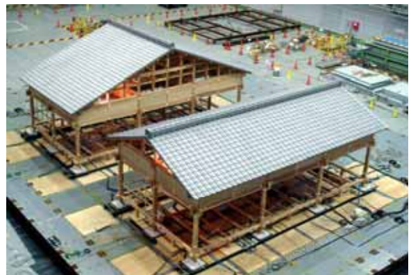
震動台上に設置された切妻屋根試験体2棟
