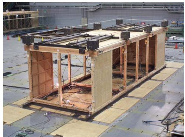
図2 1×3スパン試験体
