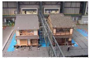
第2ステージでは、移築京町家に耐震性能評価に基づいた耐震補強を施して実験を行い、耐震補強方法の有用性を検証した。
