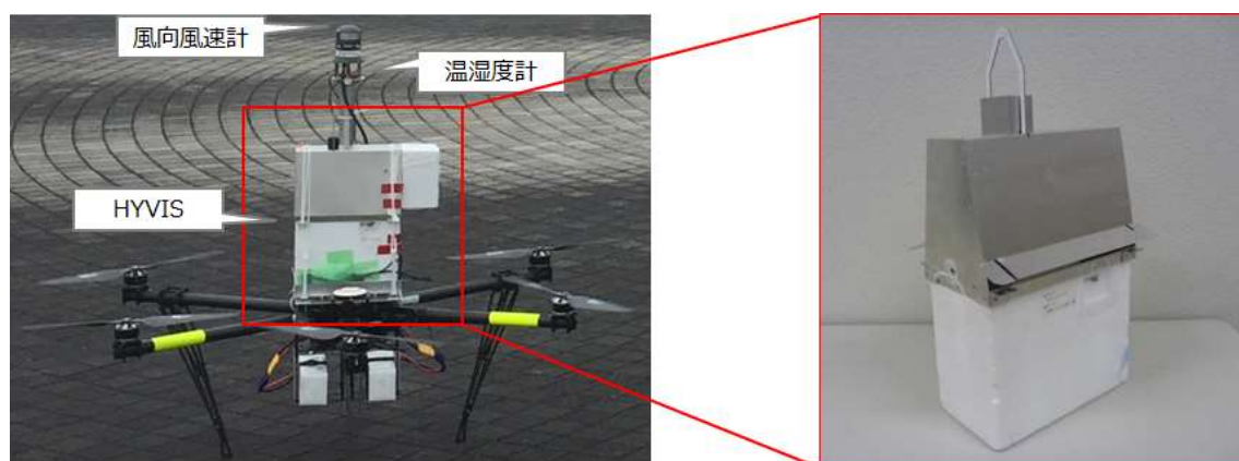
写真) 気象センサーと雲粒子ゾンデ(HYVIS)を搭載したドローン
