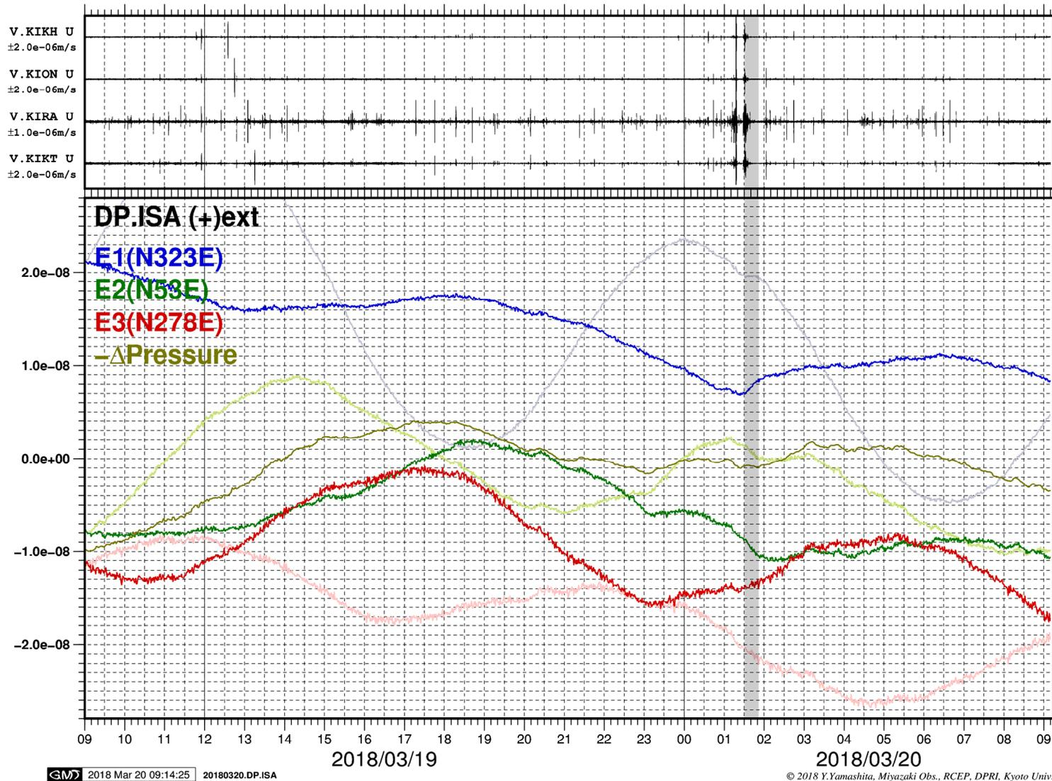
図3. 2018年3月19日09時～3月20日09時10分までの伸縮計記録（図2の時間軸を拡大した図．縦軸のスケールを10倍拡大している）．気圧変化（ $\Delta$ Pressure）は伸縮計の応答と対応を見やすくするために正負を反転させている．薄い線は潮汐補正前，濃い線は潮汐補正後のグラフを示す．
